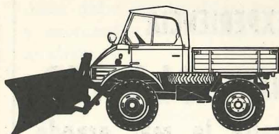
Montaje frontal: aplanadora
